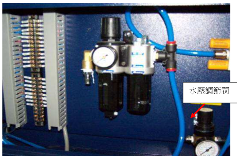
步驟5: 檢查並確認入水壓力在0.8~1 kg/cm 2 之間
