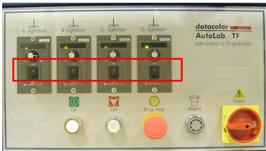
步驟3: 確認所有的攪拌速控器開關切換到"ON"的位置
